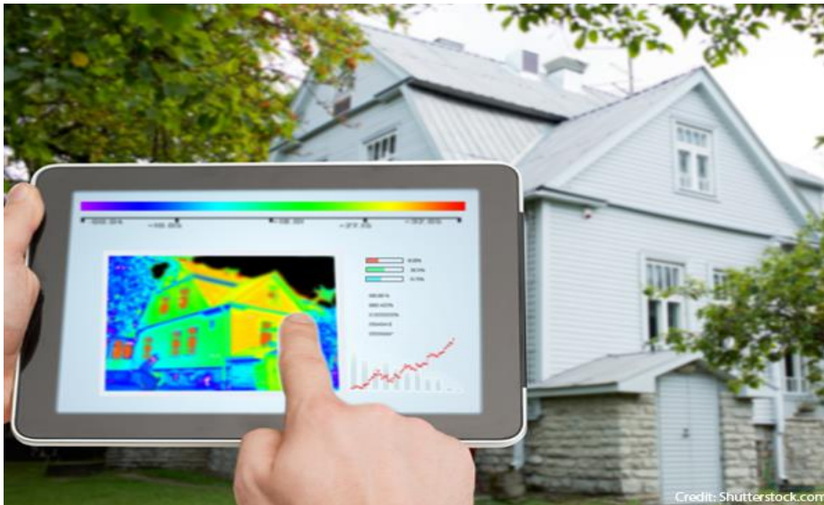
Figura 3: Una representación termográfica para detectar fugas de aire y huecos de aislamiento
